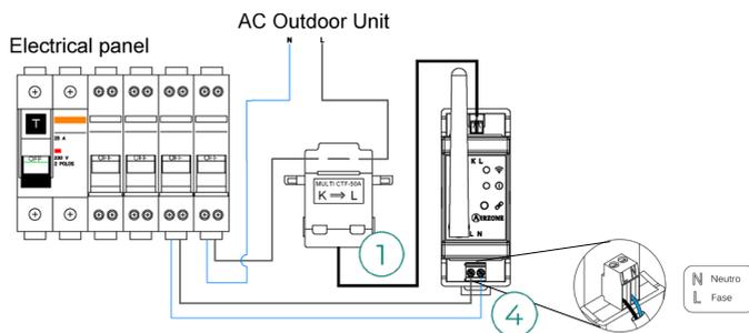
La conexión de alimentación eléctrica al módulo ④ se realiza mediante una borna de 2 pines. Fije los cables con los tornillos de la borna respetando la polaridad de la misma.
