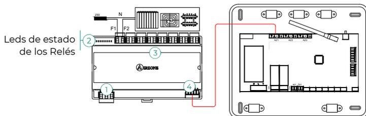
Las características de los relés de control ③ son I<sub>max</sub> de 10 A a 110/230 Vac libre de tensión. Para el control de elementos de mayor potencia se recomienda el uso de contactores de la potencia a controlar. Recuerde conectar el neutro directamente desde circuito hasta el elemento a controlar.
