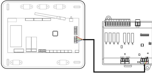
Las características de los relés de control (1)(2)(3)(4)(5) son 24 / 48 Vac libre de tensión. Para el control de elementos de mayor potencia se recomienda el uso de contactores de la potencia a controlar.
