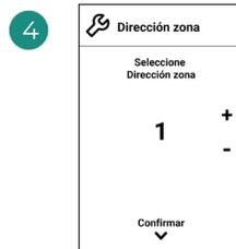
Seleccione la zona asociada a este termostato. A cada zona le corresponde una salida de control (salida para motor o relé de control de elementos radiantes).
